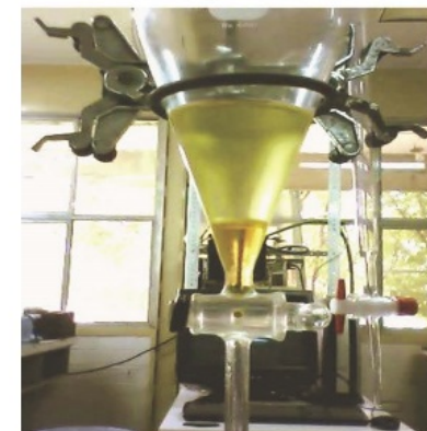
Figura 2. Aspecto del BD obtenido como un líquido de color amarillo claro y cristalino (fase superior), en la fase inferior se observa la glicerina con impurezas.
