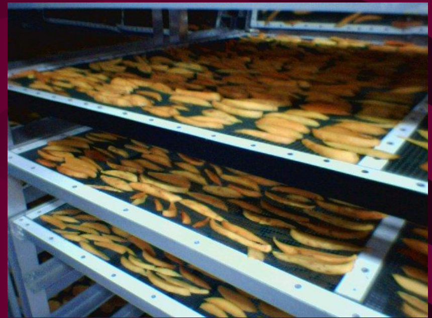
Figura 17.- Operación de la cámara de secado, donde se muestran las charolas del producto de mango a deshidratarse.
