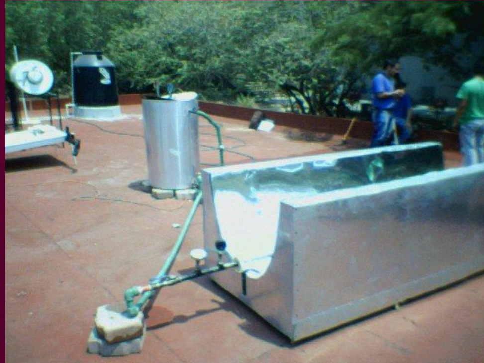
Figura 3.- Concentrador Parabólico Fijo o compuesto. CPC
