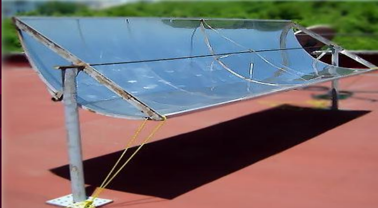
Figura 2.- Prototipo del concentrador parabólico cilíndrico
