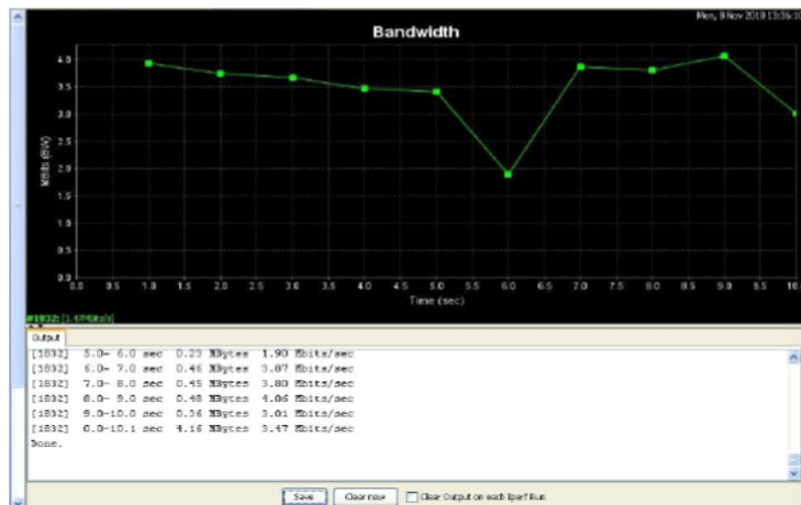
Figura 17.11. Ancho de banda del IMP al IFUNAM a través de la conexión de Internet comercial. El resultado obtenido está entre los 3 a 4 Mbps como se observa en la figura.
