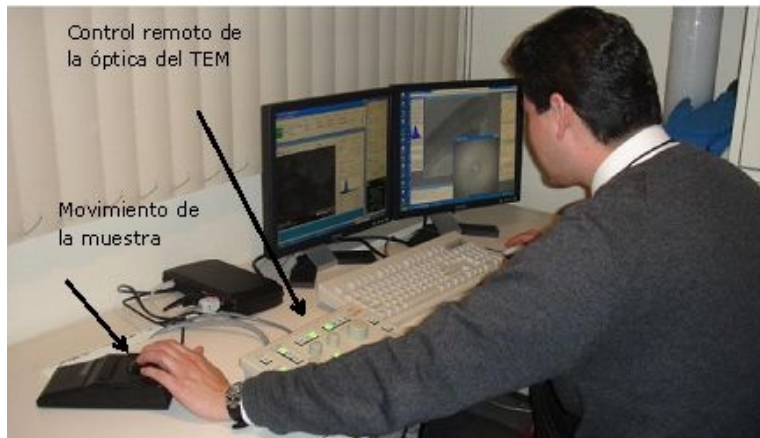
Figura 17.8. Manipulación remota por Internet del servidor de un microscopio electrónico JEOL-2200FS+Cs. Usuario remoto.
